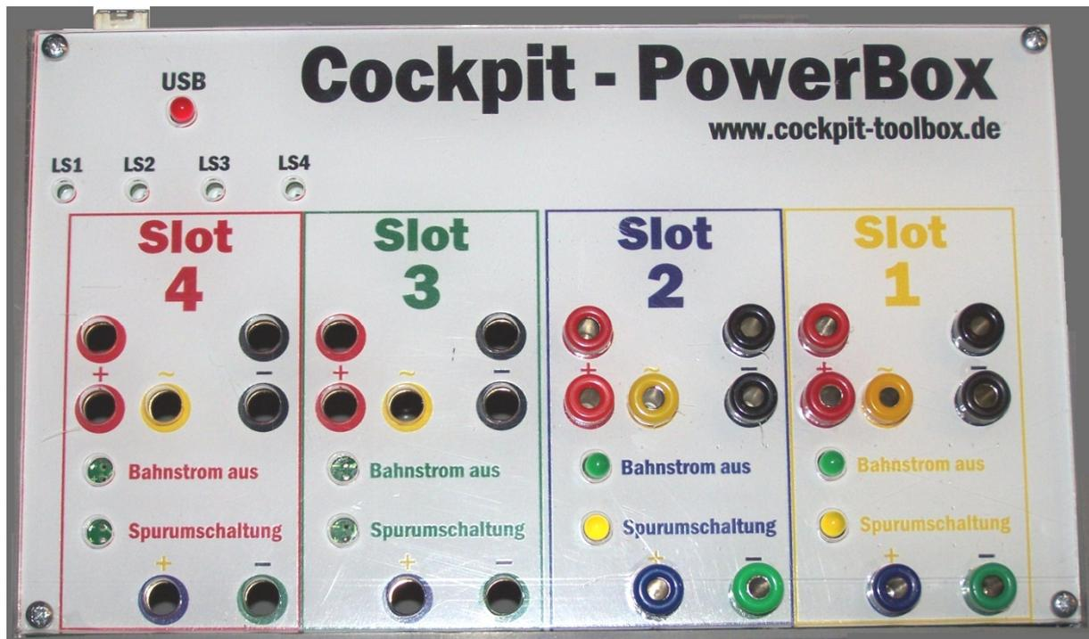
Die neue PowerBox V 2.1 (Nachfolgerin der PowerPlatine) ist für bis zu 4 Fahrspuren einsetzbar. 5-8 spurige Rennbahnen können durch den Einsatz einer weiteren PowerBox abgedeckt werden. Neben der Bahnstromabschaltung, der Fahrtrichtungsumschaltung und den weiteren Funktionen, ist eine Regleranschlussbox bereit integriert.
