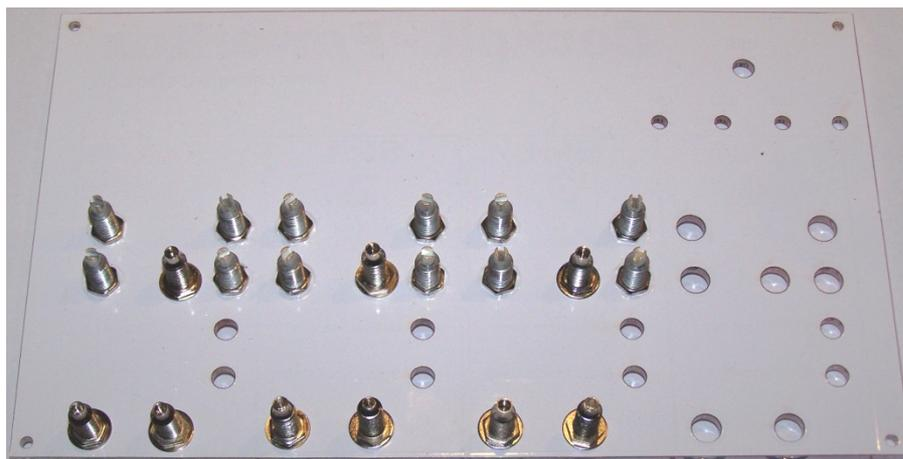
Natürlich kann eine solche Frontblende auch in Eigenregie, z.B. aus Aluminium gefertigt werden. Allerdings sind dann isolierte 4 mm Buchsen erforderlich. Die hier gezeigte Kunststoffausführung kommt ohne diese Isolierung aus.
